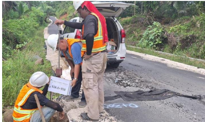
Gambar 1. Investigasi tanah dasar menggunakan Hand Auger Boring pada STA 0+500 di Ruas Jalan Paroman Sawah–Kampung Pinang, Kabupaten Pasaman Barat.
