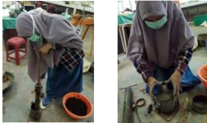
Gambar 3. Proses pencetakan benda uji
