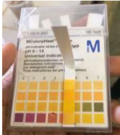
Gambar 5. Pengujian pH tanah gambut
