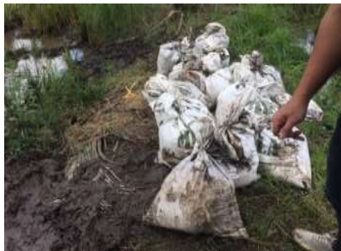
Gambar 1. Sampel tanah dimasukkan ke dalam Karung
