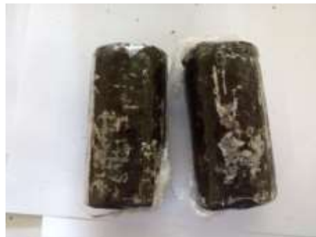
Gambar 4. Proses pemeraman benda uji
