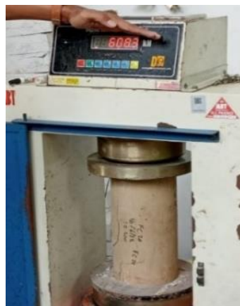
Gambar 15. Pengujian Mutu Beton
