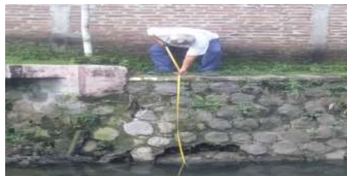
Gambar 3. Pengukuran tinggi Talud
