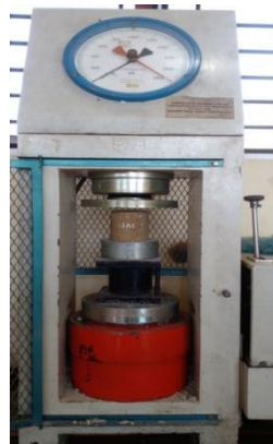
Gambar 3. Pengujian kuat tekan sejajar serat Bambu Petung
