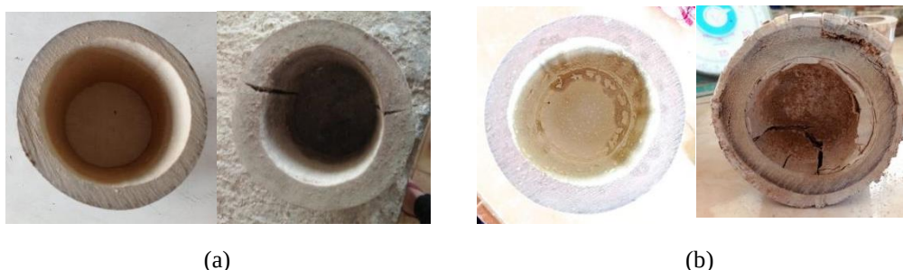
Gambar 4. Bentuk kerusakan benda uji (a) Bagian internodia (b) Bagian nodia
