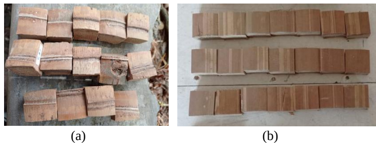
Gambar 2. Dokumentasi benda uji sifat kadar air dan kerapatan bambu (a) bagian nodia (b) bagian internodia
