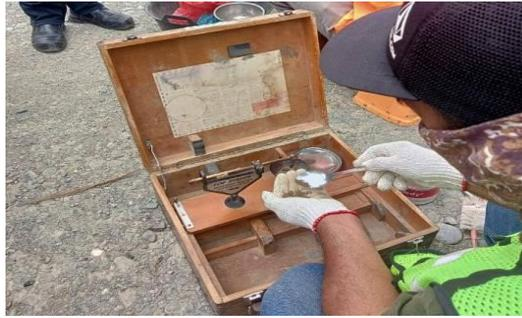
**Gambar 4.** Pengujian kadar air menggunakan alat *speedy moisture content*
