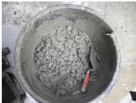
Gambar 3. Campuran beton agregat kasar batu pecah bergradasi seragam
