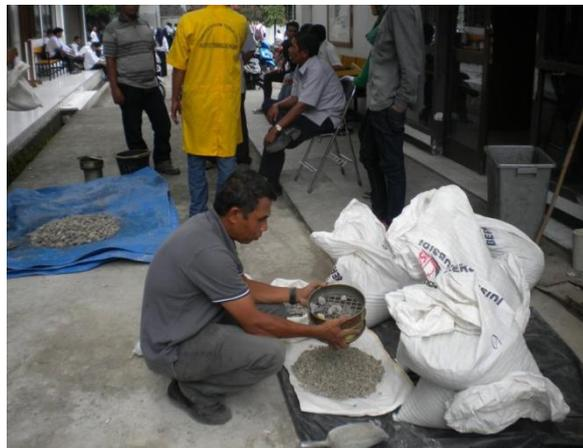
Gambar 2. Persiapan gradasi agregat kasar batu pecah
